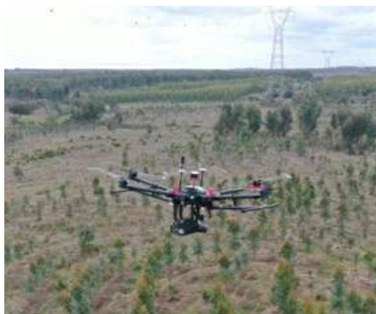
Utilização de drones com tecnologia LiDAR para deteção de anomalias em zonas percorridas por linhas elétricas (Foto: EDP Labelec)
